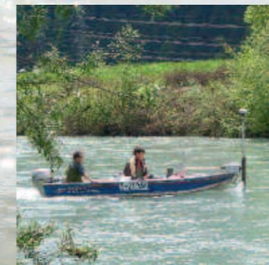
**High-tech im Messboot.** Vermessung der Drausohle mittels Echolot.
