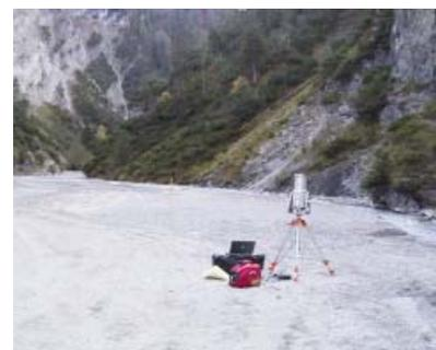
Abbildung 23: Laserscanner im Einsatz
