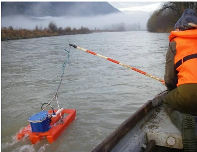
*Abbildung 15: Fließgeschwindigkeitsmessung.*
