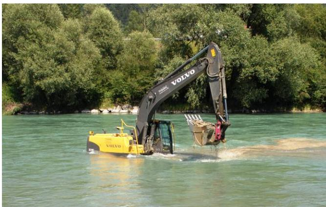
*Abbildung 16: Entnahme volumetrischer Substratproben mit dem Bagger.*
