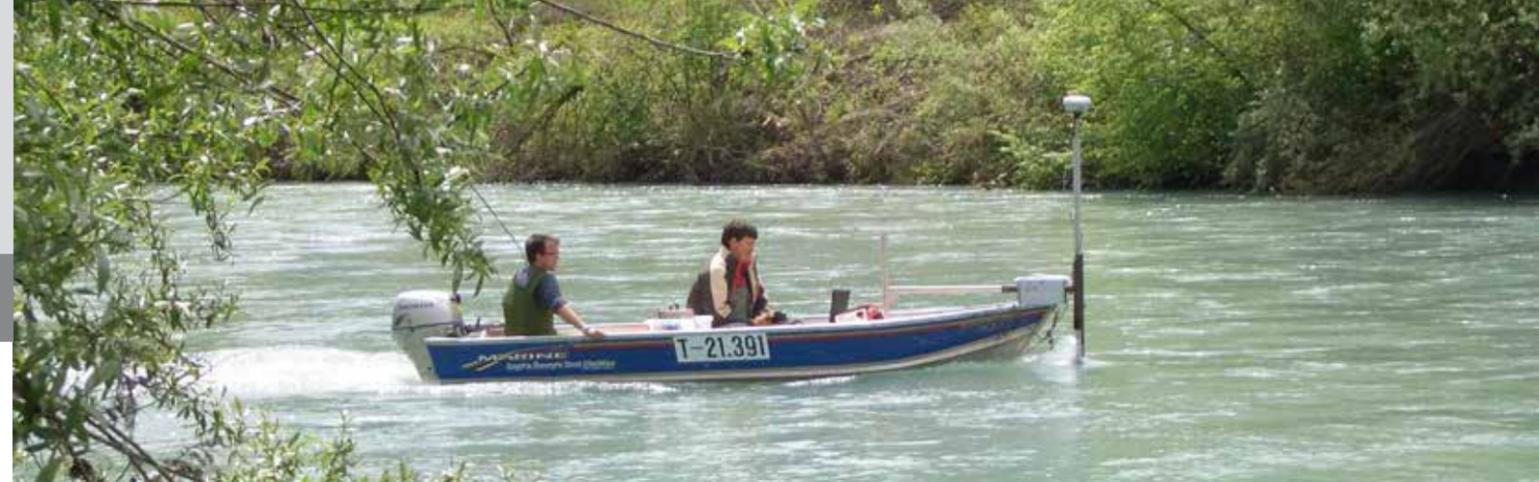
🏠 High-tech Einsatz. Vermessung der Gailsohle mittels Echolot.
