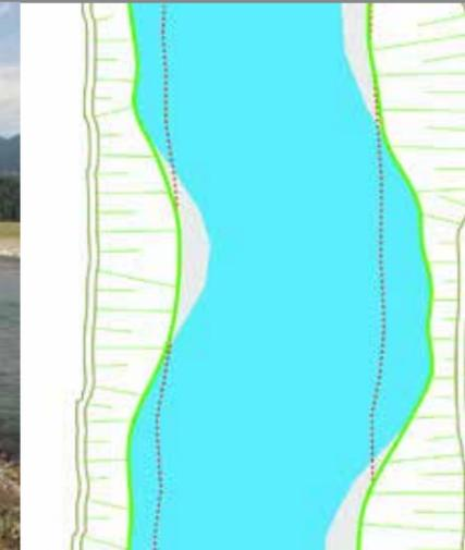
**Das Prinzip:** In der Musterstrecke 1 wird die Gail künftig stärker zwischen den Dämmen hin und her pendeln. Dazu werden die Berme abwechselnd links- und rechtsufrig entfernt und Dammböschungen abwechselnd flach und steil gestaltet. In den Prallufeln wird der Damm zusätzlich neu abgedichtet.
