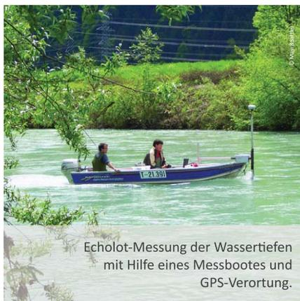
Echolog-Messung der Wassertiefen mit Hilfe eines Messbootes und GPS-Verortung.
